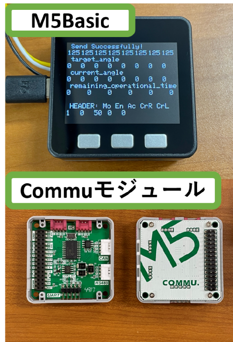
図3 重機コントローラとして採用した M5Stack と Commu モジュール
